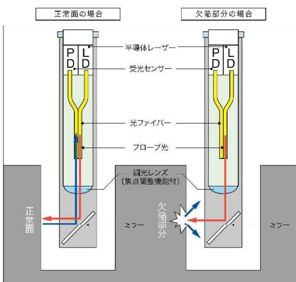
ジャイロスキャンは、検査面の「色」ではなく「状態」で検査を行っています。洗浄痕、色むら、ロット違いによる色合いの変化に影響されにくい方式です。
