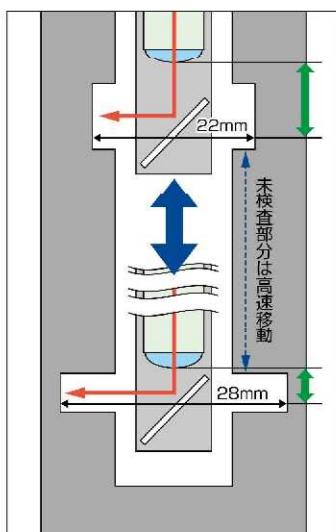
ジャイロスキャンは、可変焦点タイプのプローブを採用しています。そのため常に焦点があつた鮮明なデータを取得し、最少φ0.05mmという微小欠陥を検出することができます。
