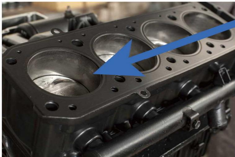
このような円筒に検査プローブを挿入し、円筒内表面に欠陥がないかを検査するものです。目視での検査を自動化することで、省力化や検査の正確性を向上することができます。
