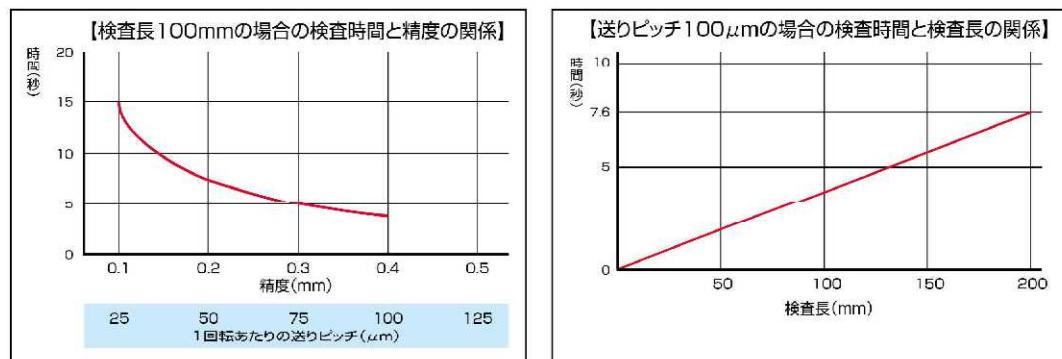
\*上記グラフはスキャン時間です。実際の検査時間はレーザープローブの昇降時間及び外部信号の応答時間がかかります。
